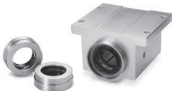
Thomson终身润滑轴承座可为轴承提供持续润滑并增强防护性能，应用十分广泛。轴承座外壳两端内置自润滑润滑油盒（最初采用EP2润滑脂）。终身润滑聚合物利用60 Case导向轴的恒定压力来确保在滚珠轴承与内圈之间形成一层润滑薄膜。
